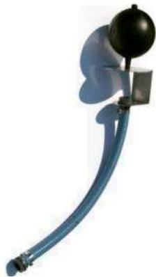
Un **tuyau de rétention** placé dans la citerne et raccordé à l'évacuation vers l'égout, permet d'évacuer l'eau à débit constant lorsque le niveau d'eau dépasse le niveau de ce raccordement.
